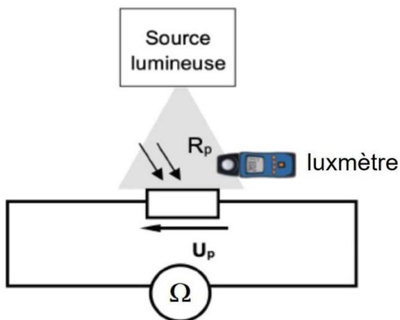
Afin de déterminer les caractéristiques du capteur de luminosité choisi, le montage n°1 ci-contre est réalisé.
