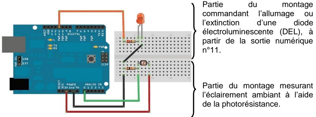
Dans la partie du montage mesurant l'éclairement ambiant à l'aide de la photorésistance, le microcontrôleur lit la tension  $U_R$  sur l'entrée analogique A0 et la convertit en un nombre entier  $N$  compris entre 0 et 1023.
