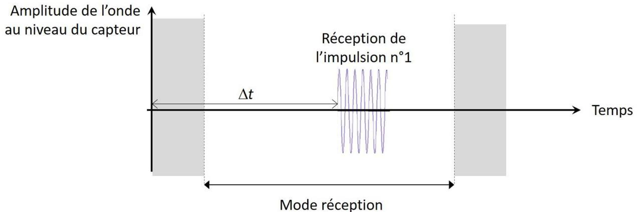
**Q25** - Montrer que la durée de chaque impulsion empêche le dispositif d'aide au stationnement de fonctionner correctement pour une distance véhicule-mur inférieure à une valeur de l'ordre de 0,1 m.
