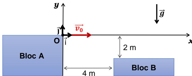
**Figure 1** : schématisation des conditions du saut
