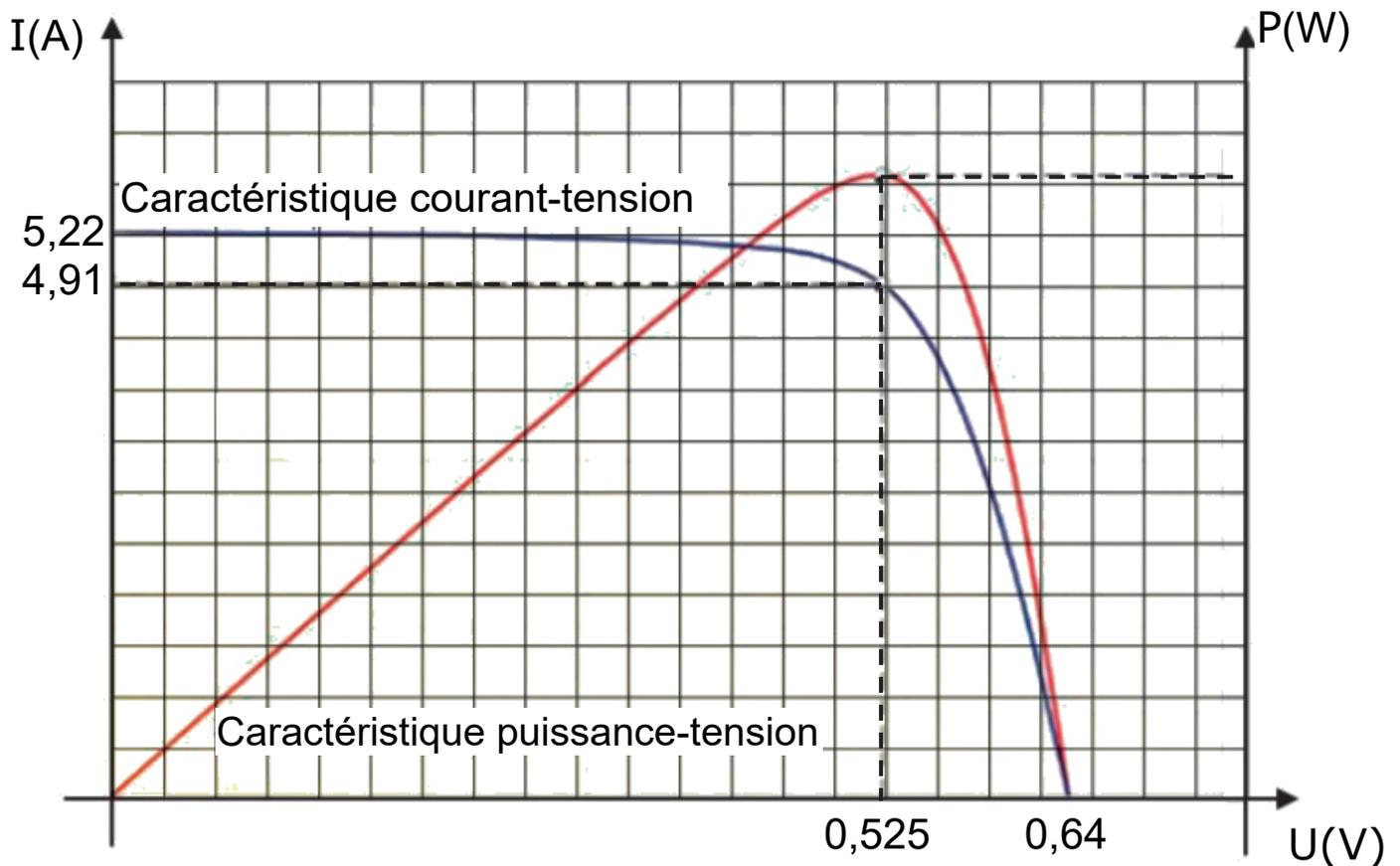
**Caractéristiques électrique d'une cellule photovoltaïque
