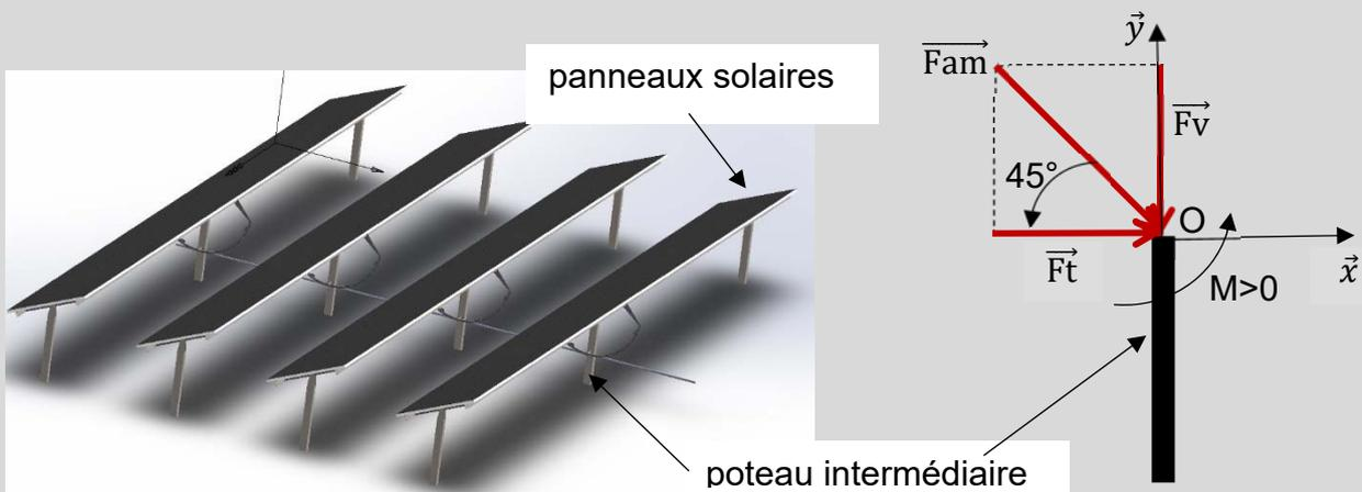
Question 4.2 | **Calculer**  $F_{am} = F_p/2$ , puis  $F_t$ , l'intensité de la résultante horizontale  $\vec{F}_t$  de  $\vec{F}_{am}$  (projection de  $\vec{F}_{am}$  sur l'axe  $\vec{x}$ ).
