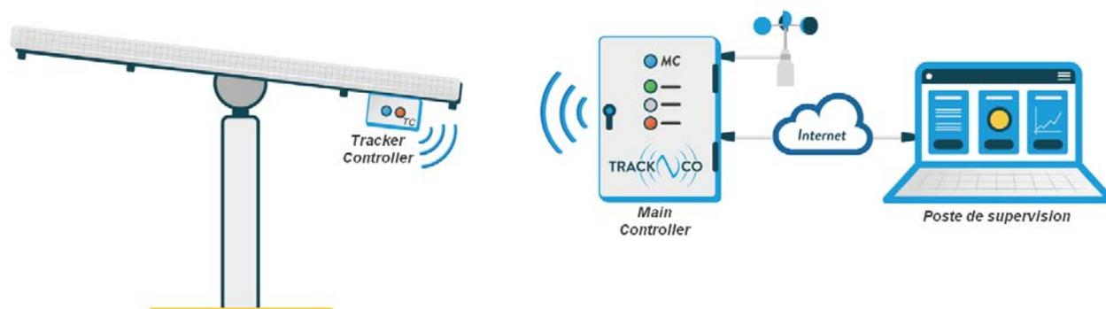
Chaque « Tracker Controller » mesure l'inclinaison des panneaux photovoltaïques et pilote automatiquement le moteur d'orientation du tracker jusqu'à sa position optimale.
