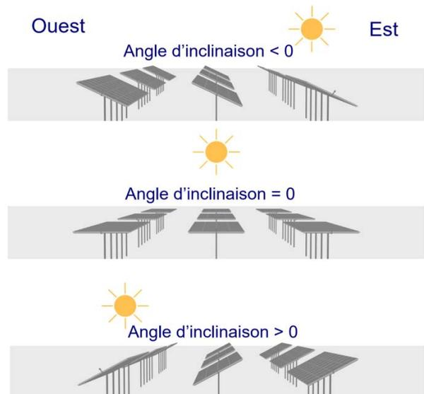
Le moteur se met en rotation lorsque la différence entre l'inclinaison optimale des panneaux et l'inclinaison mesurée est supérieure à  $0,5^\circ$
