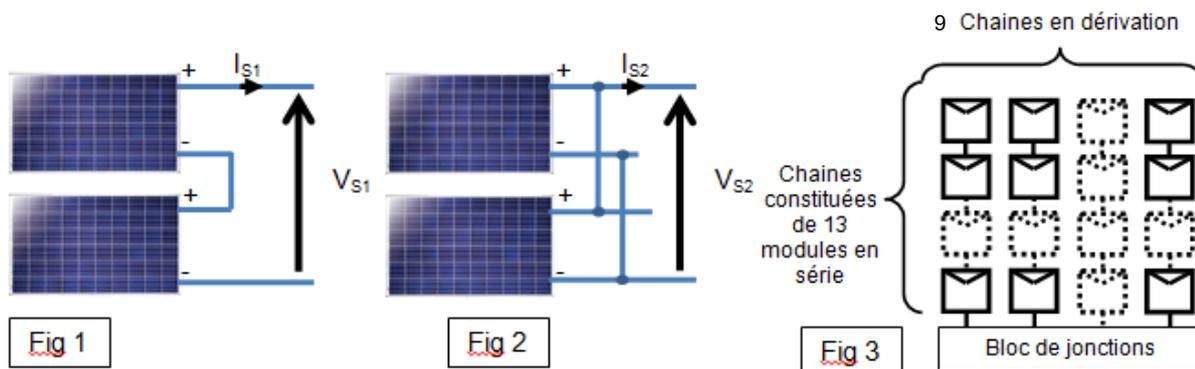
En fonctionnement normal et pour un ensoleillement de  $1000 \text{ W}\cdot\text{m}^{-2}$  la tension d'un module est de  $54,7 \text{ V}$  et le courant de  $5,86 \text{ A}$  (voir DT3).
