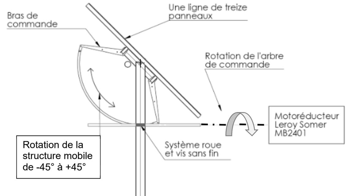
Le système de tracking permet d'orienter tous les panneaux photovoltaïques de manière à les positionner le plus longtemps possible perpendiculairement aux rayons du soleil. La problématique est de trouver la meilleure orientation tout au long de la journée.
