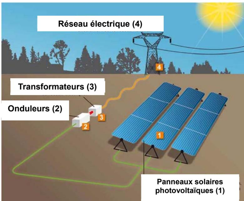
L'énergie solaire est captée par plusieurs alignements de modules photovoltaïques (1) qui la convertissent en électricité. Cette énergie électrique est modulée grâce à des onduleurs (2). Puis des transformateurs (3) élèvent la tension pour l'injecter sur le réseau (4).
