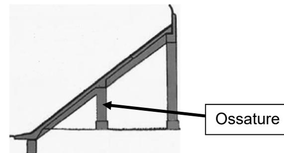
L'avantage de ce choix réside dans la mise à disposition d'espaces sous l'ossature, espaces qui peuvent alors être utilisés pour les vestiaires, les sanitaires et autres locaux de stockage vélos.
