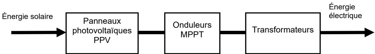
Avec un onduleur classique, la tension aux bornes des panneaux photovoltaïques est considérée comme constante.
