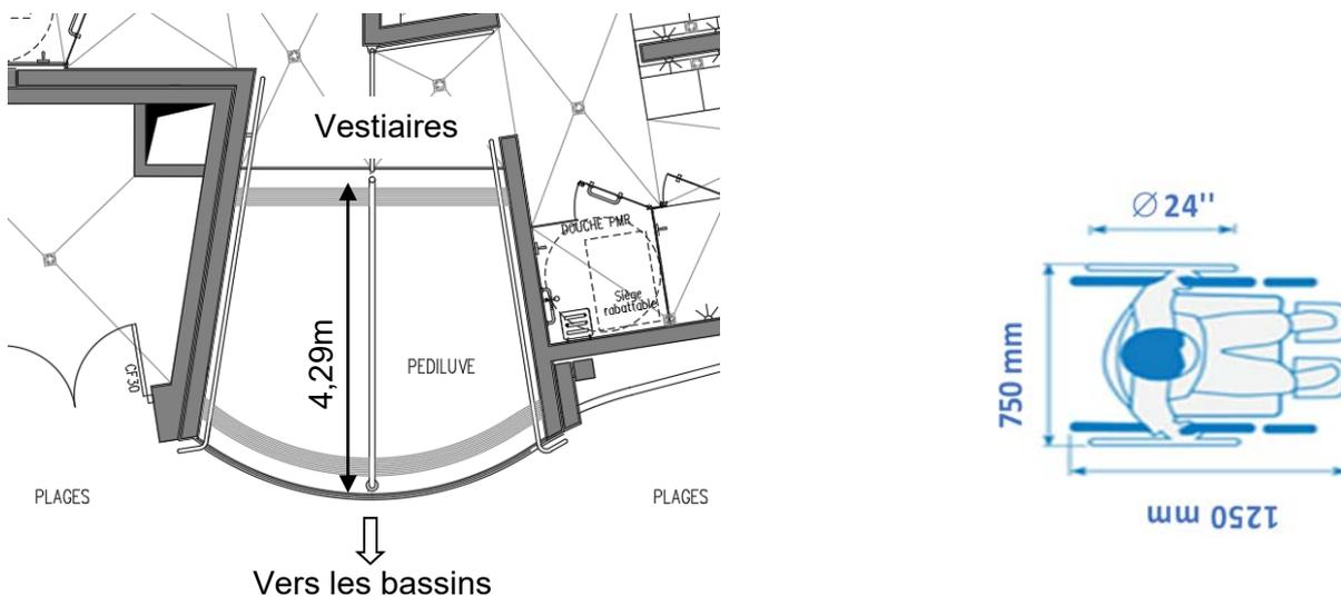
La figure ci-dessus donne le gabarit d'encombrement d'un fauteuil roulant. Une roue arrière de fauteuil a un diamètre de 24" (pouces), soit 610 mm.
