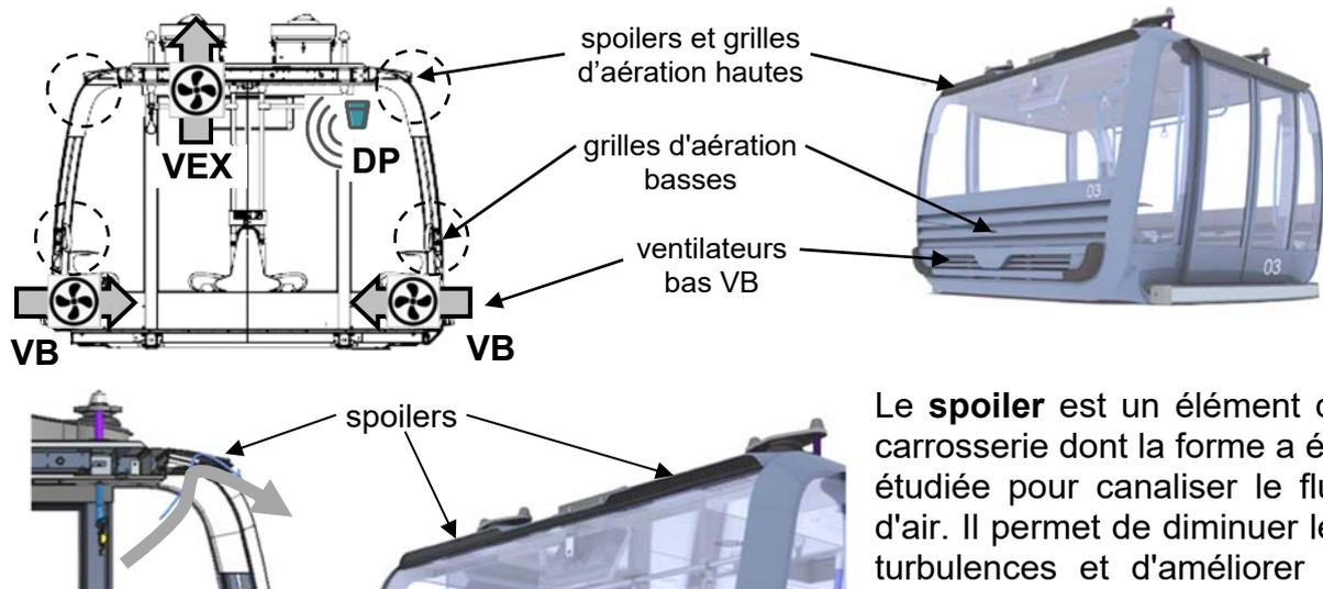
Le **spoiler** est un élément de carrosserie dont la forme a été étudiée pour canaliser le flux d'air. Il permet de diminuer les turbulences et d'améliorer le débit d'air.
