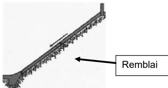
Les pistes sur remblai sont plus fréquentes et permettent une meilleure insertion dans le paysage.
