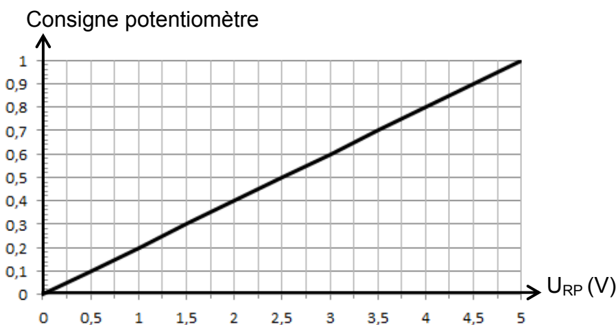
Figure 11 : consigne potentiomètre = f ( U_{RP} )
